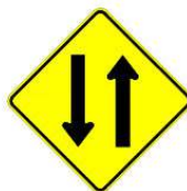
INICIO DE DOBLE CIRCULACIÓN
