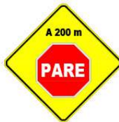
PROXIMIDAD DE SEÑAL RESTRICTIVA (Pare)
